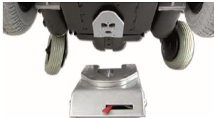
Station et plaque d'arrimage sous le châssis d'un fauteuil
