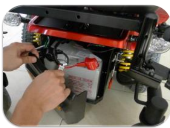
position of the front batterie
