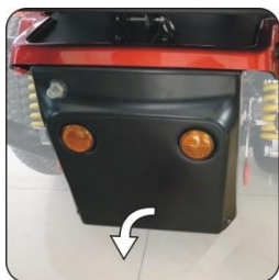
position of the front batterie
