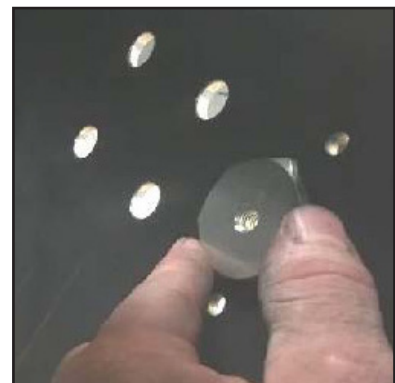
Møtrikkerne placeres i de forborede huller.
