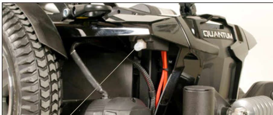
Her sidder automatsikringen.
