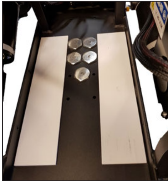
De to medfølgende plader placeres på hver side af møtrikkerne. De fastgøres med dobbeltklæbende tape eller lidt lim.
