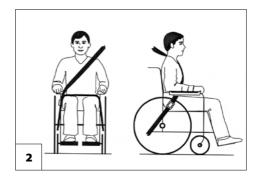
Der Becken- und Schulterschräggurt sollte ungehindert und nicht zu locker im Bereich zwischen Becken und Oberschenkel des Benutzers anliegen [2]. Legen Sie den im Transportfahrzeug eingebauten Dreipunkt-/Schulterschräggurt wie in [3] dargestellt an. – Dabei stellt die Linie (A) die Mittelinie des Körpers und die Position (B) die Mitte des Sternums (Brustbein) dar
