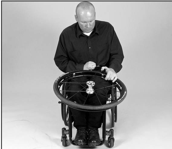
Fig. 55 Pull the tire edge over the rim
