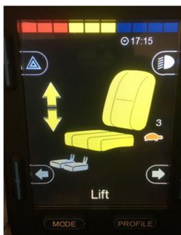
Joystick nach hinten auslenken: Lift hebt an
