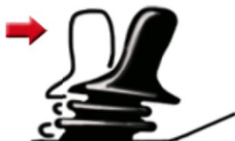
Wenn der Joystick ausgelenkt ist, bevor das System komplett eingeschaltet ist, blinkt dieses Symbol im Display.
