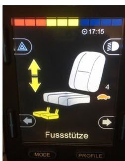
Joystick nach hinten auslenken: Fussstütze wird angehoben
