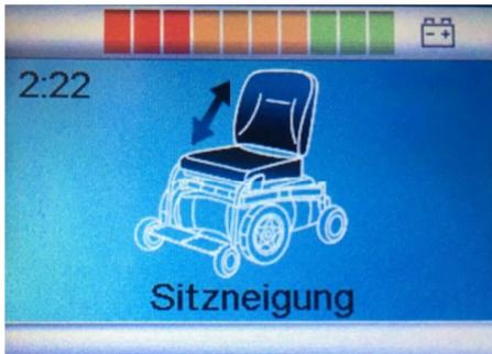
2. Blättern Sie mittels Joystickbewegung links oder rechts bis zur gewünschten Sitzverstellungsfunktion (z.B. Sitzneigung oder Lift)
