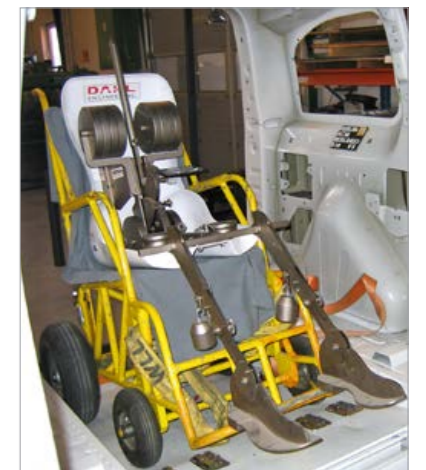
ECE-Regulative 14 H-Punkt Vermessung
