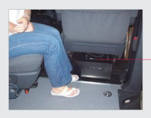
Console de siège, pour siège passager origine constructeur, permettant une meilleure aisance aux pieds (+10 cm au sol) en cas de rotation du siège ( siège avec option embase pivotante).
