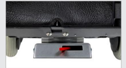
Eine Verriegelungsplatte und ein Zwischenstück müssen unter dem Rollstuhl angebracht werden. Wenn der Rollstuhl zur Docking-Station gefahren wird, wird er mit Hilfe der Verriegelungsplatte in die richtige Position gebracht und automatisch verriegelt.
