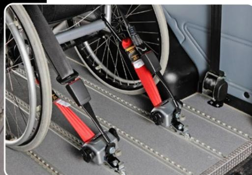
Die Gurtschlösser sind an den hinteren Befestigungsretraktoren montiert und der automatische 3-Punkt Sicherheitsgurt wird in bequemer Höhe schnell und einfach an diesen befestigt.
