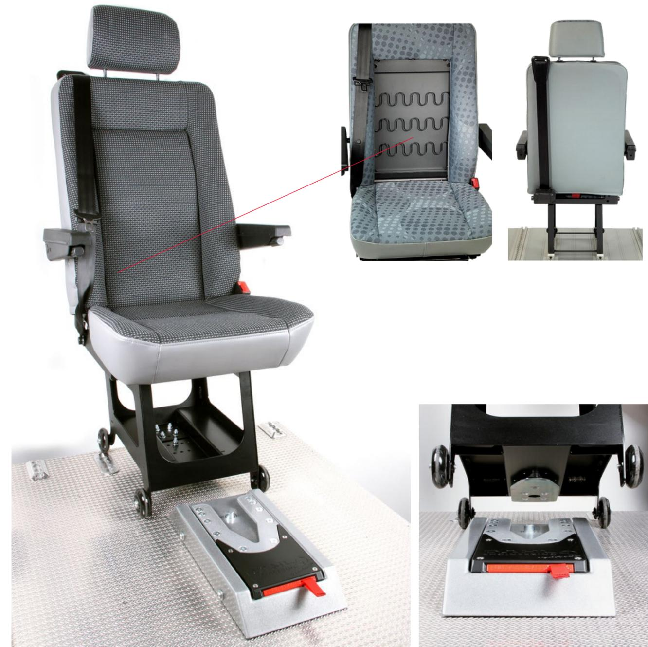
Dieser für Kleinbusse erhältliche Sitz mit eingebautem 3 Punkt-Gurt, ist mit einer besonders große Seitenstütze und als einziger Sitz in dieser Klasse Polsterfedern in Sitzfläche und Rückenlehne ausgestattet.
