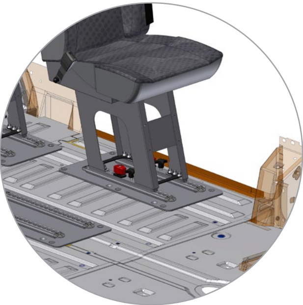
Forstærkningsdelene er tilpasset det enkelte monteringssted – også omkring brændstoftanken.
