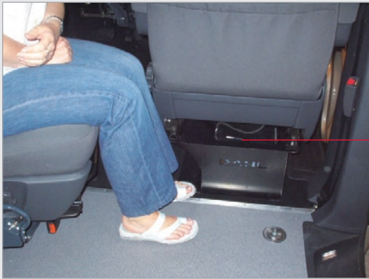
Console de siège, pour siège passager origine constructeur, permettant une meilleure aisance aux pieds (+10 cm au sol) en cas de rotation du siège (siège avec option embase pivotante).
