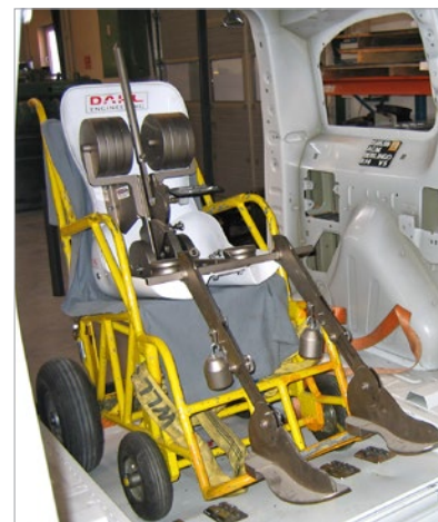
Règlement ECE 17 - Mesure du point H
