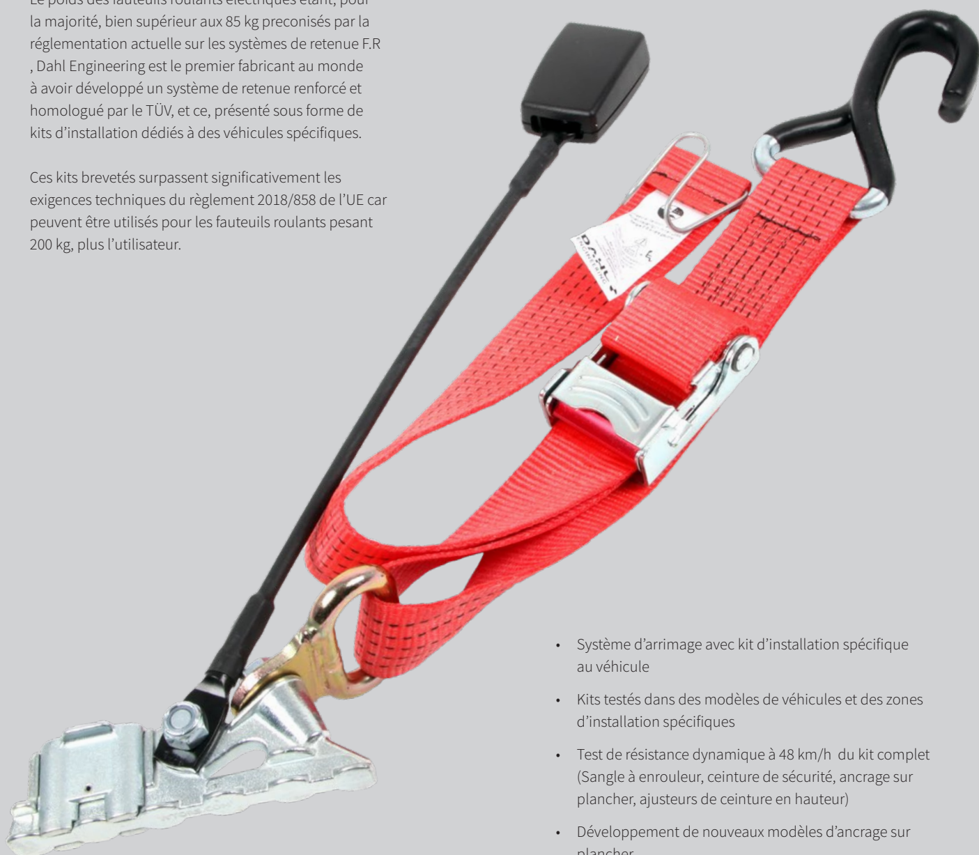
Système de retenue pour fauteuils roulants jusqu'à 200 kg + utilisateur
